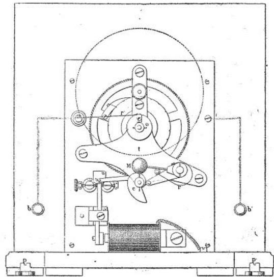
Le récepteur se compose d'un cadran divisé en 20 ou 25 cases et une croix. Un aiguille très forte munie d'une poignée obéit à un rouage intérieur. Ce rouage, très simple est commandé par un échappement sur lequel agit l'armature d'un électro-aimant.
