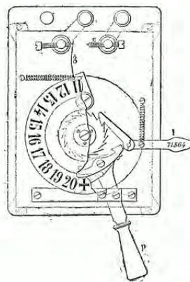
Le transmetteur est formé par un cadran avec un certain nombre de divisions correspondant aux signaux à envoyer. Au moyen d'une manette L déplacée de droite à gauche, on actionne un contact qui ferme le circuit sur le fil de la ligne, en même temps, on fait avancer d'une dent
